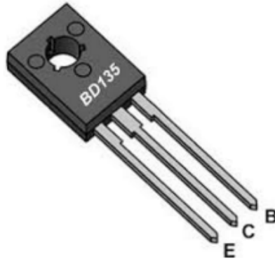
Şekil 1.13. BD135 transistör ve bacak bağlantıları
